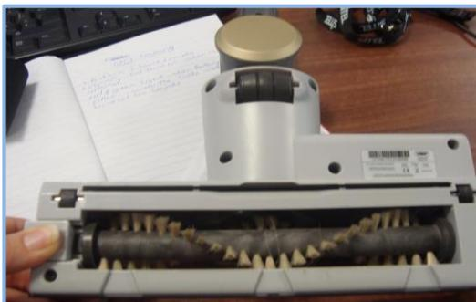
Entnehmen Sie die Bürstwalze durch Schieben der Bürstwalzenentriegelung.
