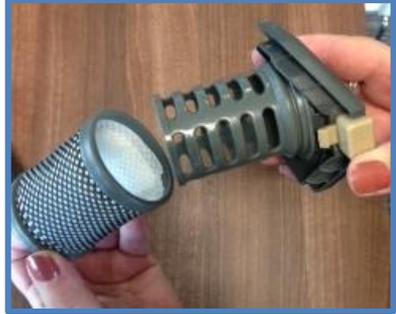
Klopfen Sie den Filter und die Filterabdeckung bzw. den Filterhalter über einem Abfalleimer aus, um Staub und Schmutz zu entfernen. Waschen Sie den Filter unter laufendem Wasser (max. 40 °C). Lassen Sie ihn über eine Dauer von 24 Stunden bzw. bis zur vollständigen Trocknung trocknen, bevor Sie ihn wieder einsetzen.
