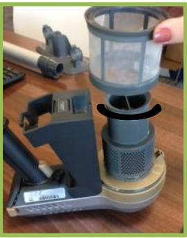
Entfernen Sie den Netzfilter und **ANSCHLIESSEND** den Separator, indem Sie sie gegen den Uhrzeigersinn drehen.
