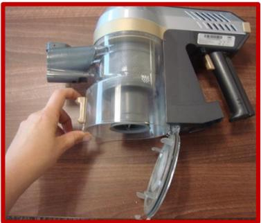
Entleeren Sie zuerst den Staubbehälter über einem Abfalleimer.
