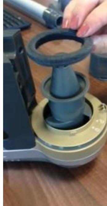
Diese Dichtung ist nicht am Gerät befestigt, und wenn sie fehlt oder beschädigt ist, wird die Saugleistung verringert, oder der Separator lässt sich nicht korrekt einsetzen.
