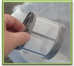
Klopfen Sie den Netzfilter und den Separator über einem Abfalleimer aus, und entfernen Sie jeglichen Staub/Schmutz mit einem trockenen Tuch oder einer Staubbürste.
