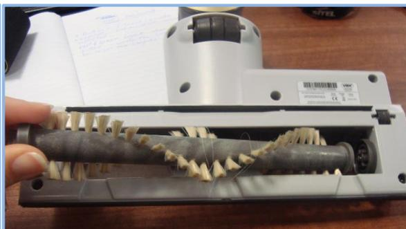
Entnehmen Sie die Bürstwalze, und beseitigen Sie vor dem Wiedereinsetzen sämtliche Haare und Fäden.
