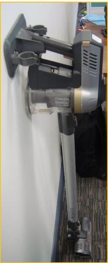
Befestigen Sie den SlimVac an der Wandhalterung, und lehnen Sie ihn an die Wand an (wobei die Turbobürste flach am Boden aufliegen muss). Fixieren Sie die Halterung an dieser Stelle mit der Hand, und entfernen Sie den SlimVac. Setzen Sie mit einem Bleistift die Markierungen für sämtliche Schrauben. Befestigen Sie die Wandhalterung mithilfe von Dübeln und Schrauben, und decken Sie die Schrauben mit Schraubenabdeckungen ab.
