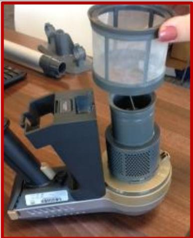
Entnehmen Sie den Netzfilter und den Separator aus dem Inneren des Schmutzbehälters.
