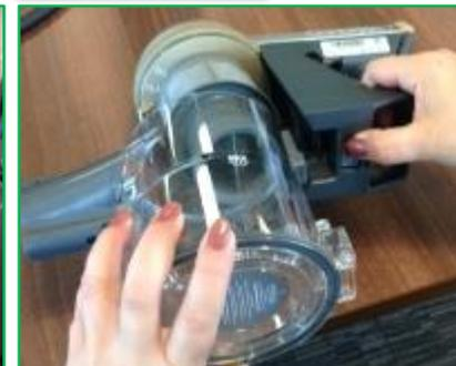
Hängen Sie die Vorderseite des Staubbehälters in das Gerät ein. Drücken Sie den Staubbehälter nach oben, sodass er einrastet.
