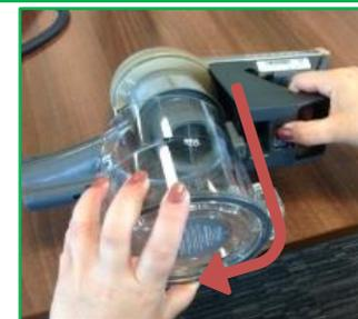
Drücken Sie zum Entfernen des Staubbehälters die Entriegelungstaste des Staubbehälters. Ziehen Sie den Staubbehälter heraus, um den Staubbehälter vom Handsauger abzunehmen.
