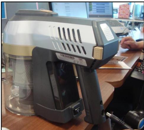
Wenn der Akku in das Gerät eingesetzt ist, schließen Sie das Ladekabel an der Rückseite des Handsaugers an.
